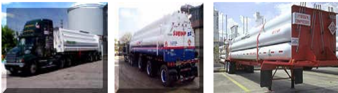
Εικόνα 18. Βυτία υδρογόνου με ασάλινους κυλίνδρους
