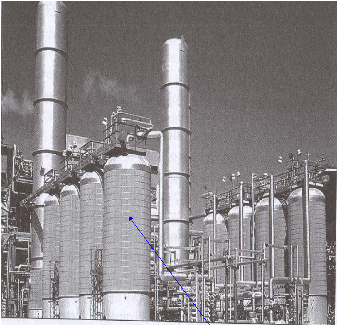
Εικόνα 2. Τμήμα εργοστασίου H_2 όπου γίνεται Pressure swing adsorption στις ΗΠΑ διακρίνεται η κλινοειδής σε σειρά διάταξη των υποστρωμάτων
