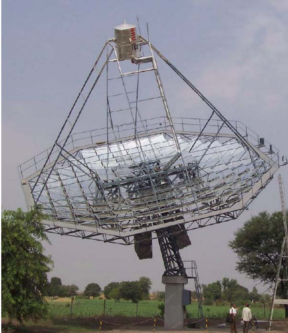
Εικόνα 5. Ηλιακός συλλέκτης σε σχήμα παραβολικού πιάτου.
