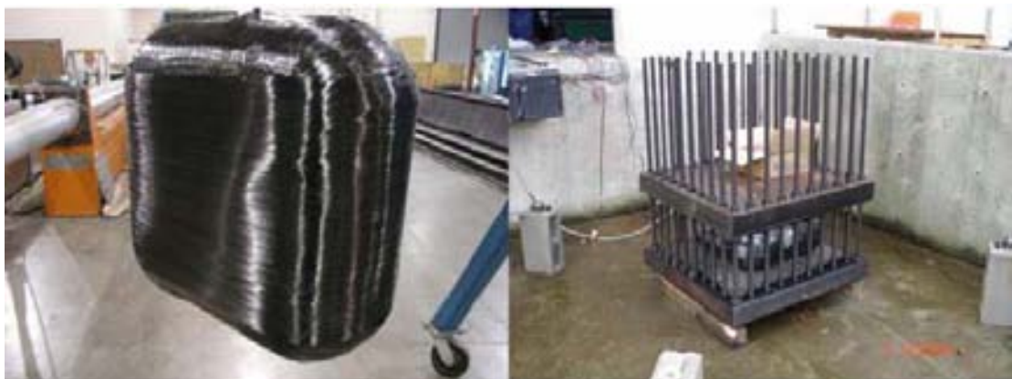
Εικόνα 35. Διατάξεις δεξαμενών με βελτιωμένη μηχανική αντοχή σε τεστ αντοχής πίεσης (μαξιλάρι)
