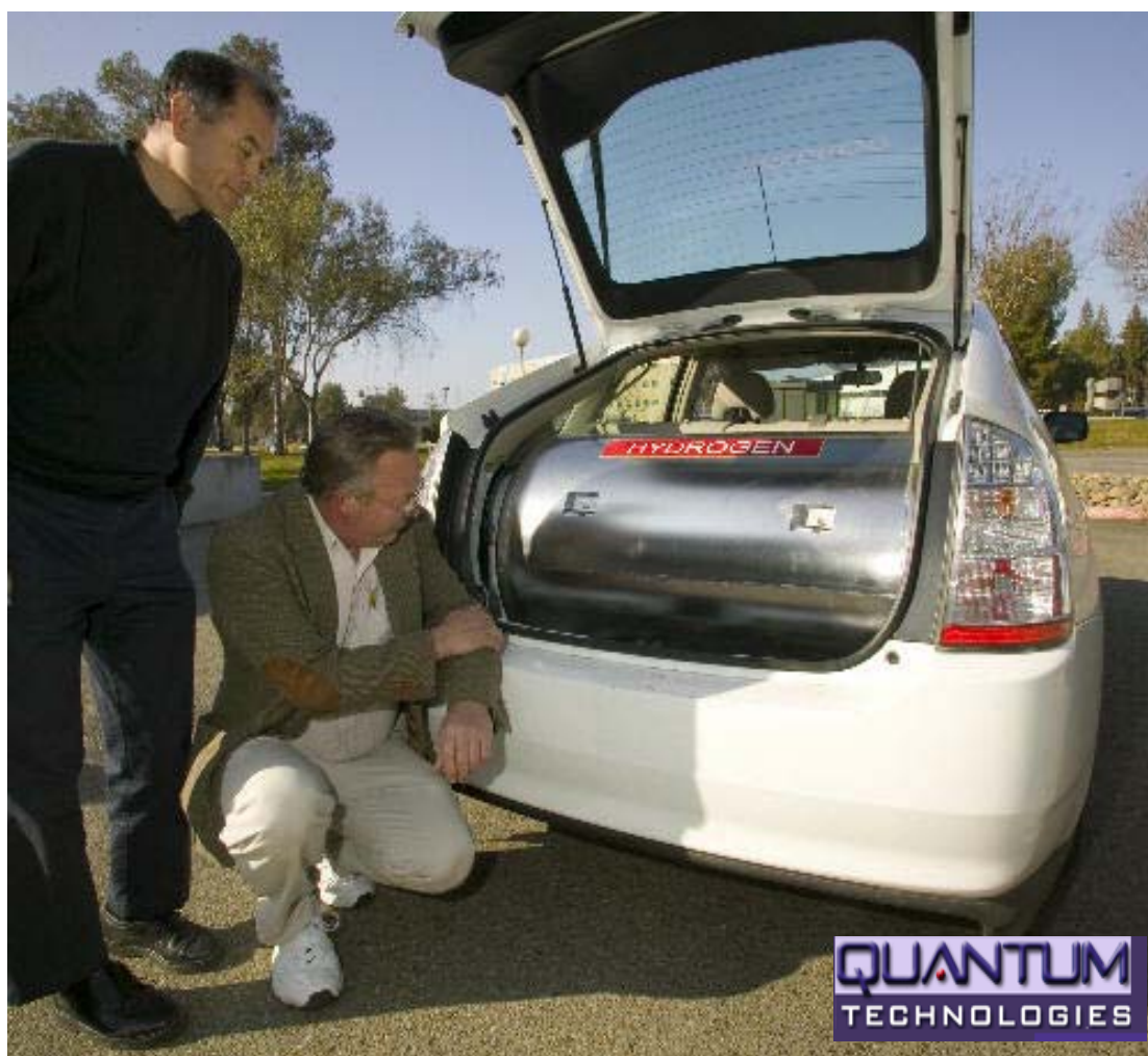
Εικόνα 34. Κρυογενής δεξαμενή LH_2 τρίτης γενιάς στα Toyota Prius. (2005).
