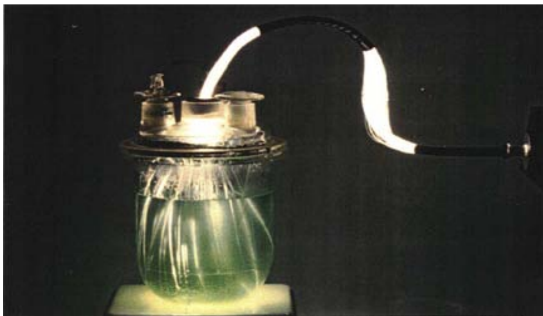
Εικόνα 11. Εργαστηριακή παραγωγή υδρογόνου από άλγη, ΗΠΑ 1978
