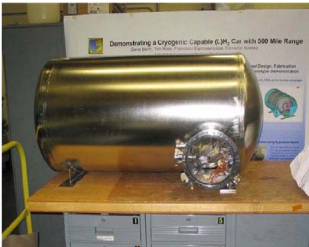
Εικόνα 33. Κρυογενής δεξαμενή υγροποιημένου υδρογόνου τρίτης γενιάς
