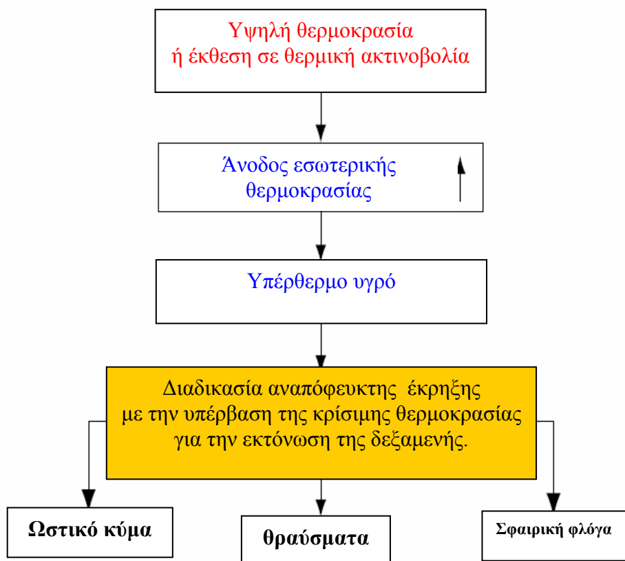
Σχήμα 95. Τα στάδια έως την έκρηξη δεξαμενής που περιέχει υδρογόνο.
