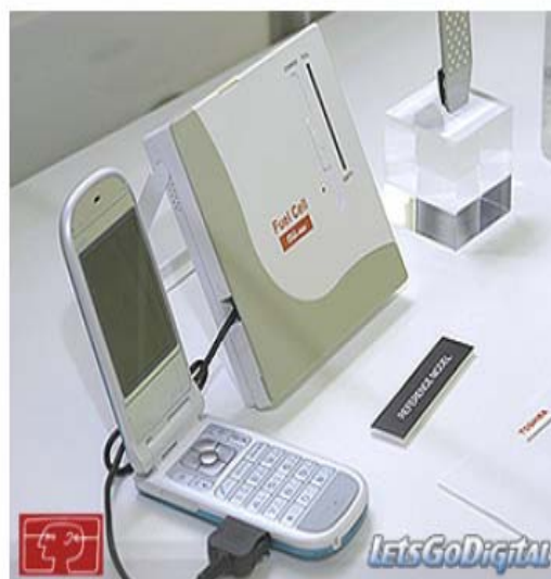
Εικόνα 52. Κυψέλες καυσίμου μεθανόλης με δυνατότητα ανεφοδιασμού τους με μεθανόλη από τον καταναλωτή.
