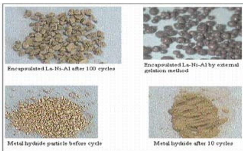
Εικόνα 37. Η υποβάθμιση του προϊόντος υδριδίου μετάλλου με την φόρτιση – αποφόρτιση
