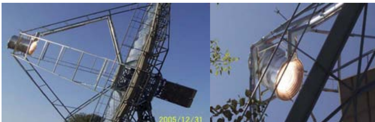
Εικόνες 7 και 8. Το κάτοπτρο σε χρήση, διακρίνεται και ο συλλέκτης ακτινοβολίας.
