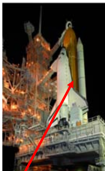
Σχήμα 48. Εξωτερική δεξαμενή καυσίμων του διαστημικού λεωφορείου διακρίνεται η μεγάλη ποσότητα υγρού υδρογόνου
