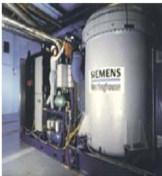
Εικόνα 54. Αντιδραστήρας καυσίμου στερεού οξειδίου (SOFC) σωληνοειδής συστοιγία 2 MW.
