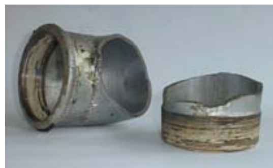
Εικόνα 67. Αγωγός που καταστράφηκε από διείσδυση υδρογόνου.
