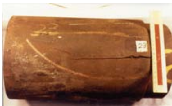
Εικόνα 67. Αγωγός που καταστράφηκε από διείσδυση υδρογόνου.
