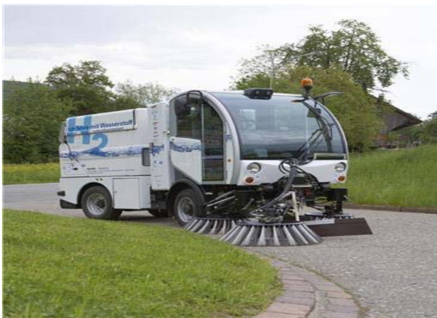
Εικόνα 59. Τα νέα οχήματα σάρωθρα που κινούνται με H_2
